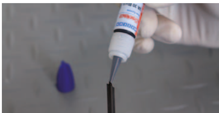
3 Нанесите клей VA 1401 на срез уплотнителя
