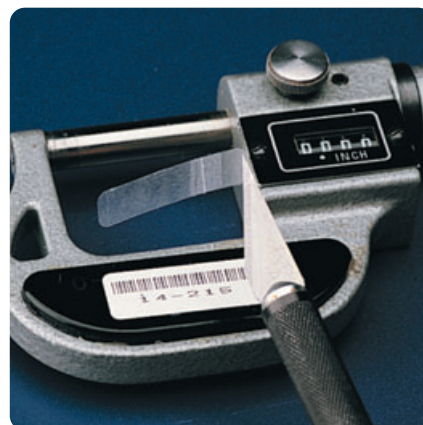
Ламинация защищает штрих-коды от грязи, масла и выдерживает истирание, не теряя читаемости
