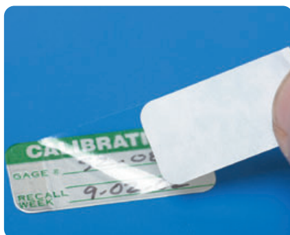
3. Подложка удаляется с бирки и затем на нее наносится ламинация
