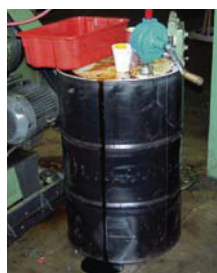
Покрывтия для бочки защищает пол от протечек и проливов.
