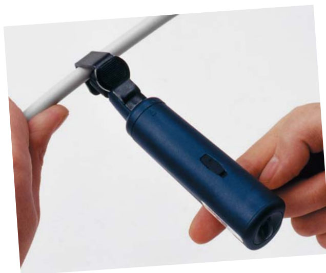
Снятие оболочки и разделка в одной операции.
